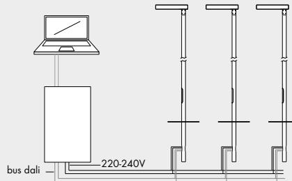
stepDIM: atenuación a un nivel programado en el alimentador durante el montaje en Viabizzuno. la atenuación se acciona mediante un único interruptor remoto (un timer, por ejemplo).
