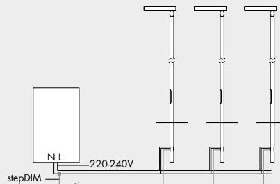
astroDIM: atenuación a dos niveles programados en el alimentador durante el montaje en Viabizzuno. el alimentador (conectado a un sensor crepuscular) calcula la medianoche virtual y la variación de luz se efectúa automáticamente conforme al programa precargado en el alimentador.
