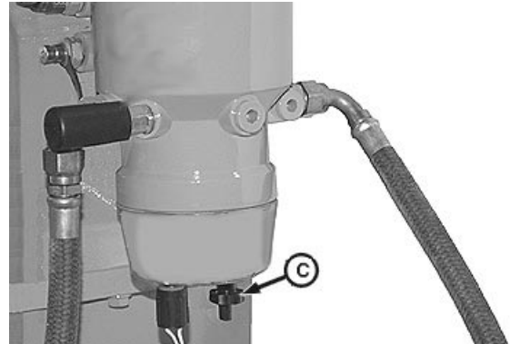
Vaciado del tazón de sedimento de combustible
