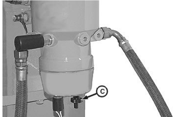
Vaciado del tazón del separador de agua
