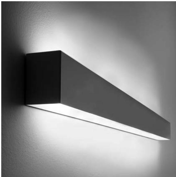
cuerpo iluminante de pared para interiores IP20 en acero inoxidable bruñido o en metal pintado en blanco o gris. en dos versiones 120 (l. 1200mm) y 150 (l. 1500mm). ambas están cableadas con un portalámparas G5 y pueden llevar respectivamente tubos fluorescentes de 28W/54W y 35W/49W/80W, con pantalla de policarbonato difusor o policarbonado prismático.
