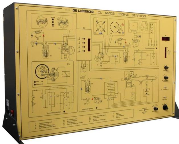
El simulador toma en consideración las técnicas de encendido utilizadas en el motor a ciclo Otto. Se analizan los principales tipos de encendido:
