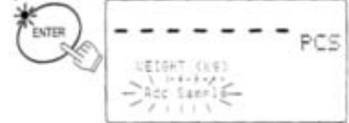
⚠ En este momento la báscula puede decidir que 10 piezas no es una muestra suficientemente grande para un conteo exacto. Si usted ve nuevamente en la pantalla el mensaje de agregar muestra ("Add Sample"), entonces agregue el número de piezas adicionales que le indica la báscula.
