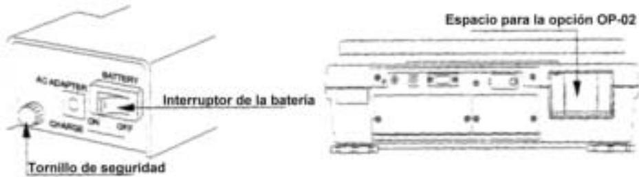
2. Apriete el tornillo de seguridad del paquete de baterías.
