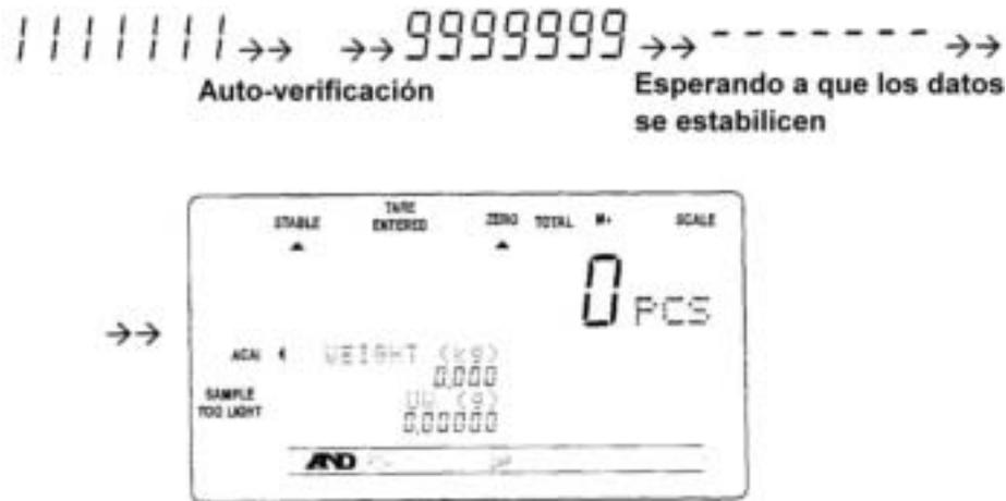
3. Por favor deje el interruptor de la báscula en posición de encendido para “calentar” la báscula durante, al menos, 30 minutos mientras que el adaptador AC es conectado, antes de utilizarse.
