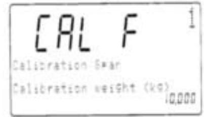
5. Coloque la masa de calibración sobre el plato de pesado y presione la tecla **ENTER**. Cuando se ha completado la calibración SPAN, la pantalla mostrará el mensaje "Calibration End".
