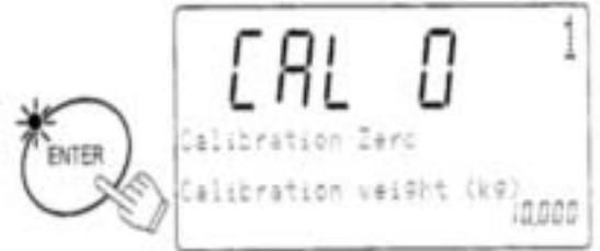
4. Asegurándose de que no hay objetos sobre el plato de pesado, o bien tocándolo, presione la tecla **ENTER**. Cuando la calibración de **ZERO** se ha completado, la pantalla mostrará "CAL F".
