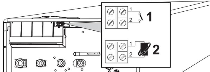
fig. 7 - Acceso a la regleta de conexiones
