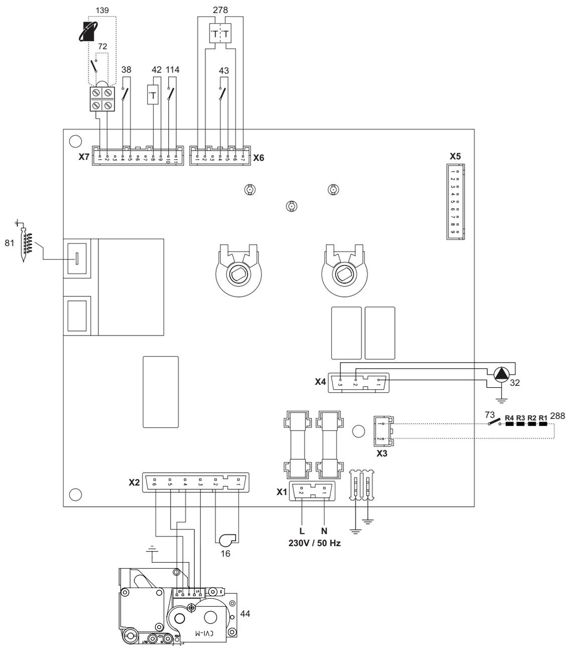
fig. 21 - Esquema eléctrico
