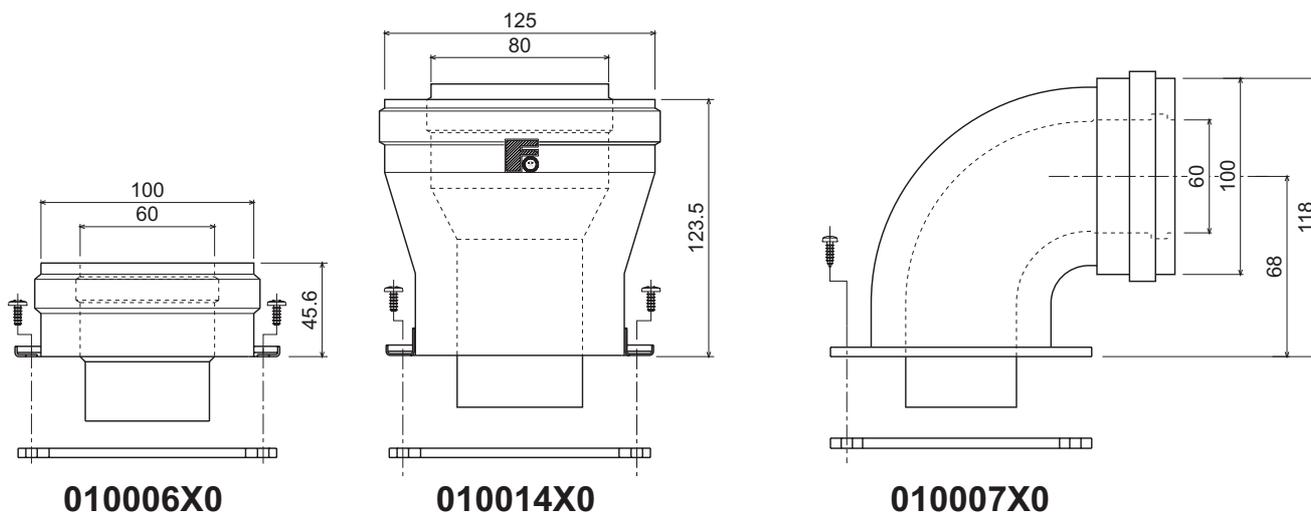
fig. 10 - Accesorios iniciales para conductos coaxiales
