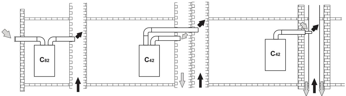
fig. 13 - Ejemplos de conexión a chimeneas (⇨ = aire / ⇨ = humos)
