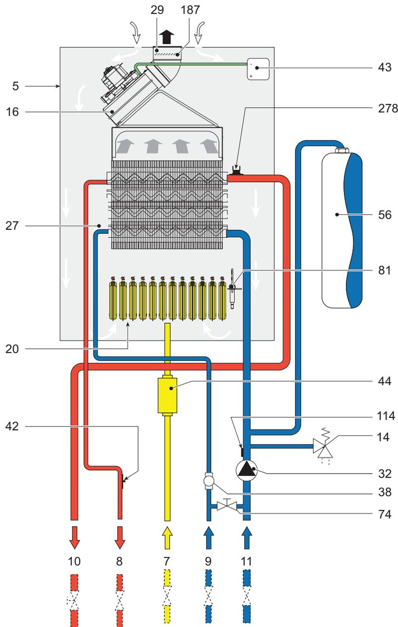
fig. 20 - Circuito hidráulico
