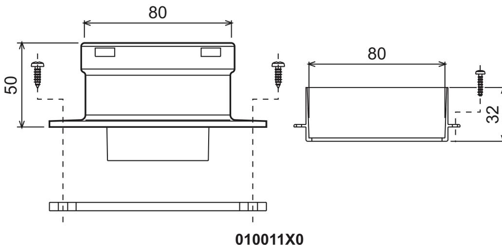
fig. 12 - Accesorio inicial para conductos separados
