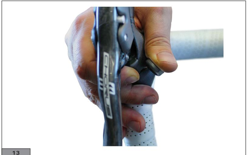
Introducir el cable del cambio (longitud 2.000 mm -  $\varnothing$  1,2 mm) en la parte inferior del mando (B - Fig. 14).
