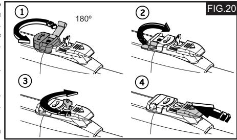
5º Conecte el equipo y realice algunas maniobras para comprobar que el Accionamiento ha sido bloqueado y la instalación funciona correctamente.
