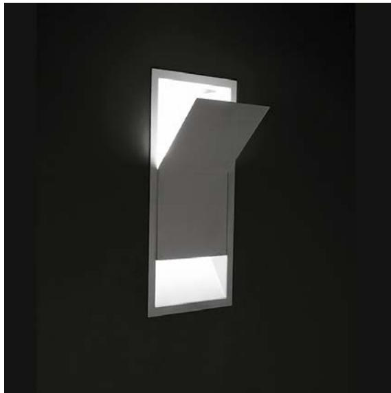
cuerpo iluminante de empotrar, para interiores IP20, con doble fuente de luz, realizado en metal barnizado blanco o gris. puede utilizarse en superficies de ladrillos, mediante encofrado al efecto, y de cartón yeso. aloja bombillas halógenas lineales con casquillo R7s-114 de 150W.
