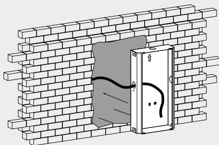
1 realizar un hueco en la pared para introducir la arqueta de ladrillo. colocar la arqueta de ladrillo en el hueco realizado, haciendo pasar los cables de alimentación y terminar el trabajo revocando a ras de la arqueta.
