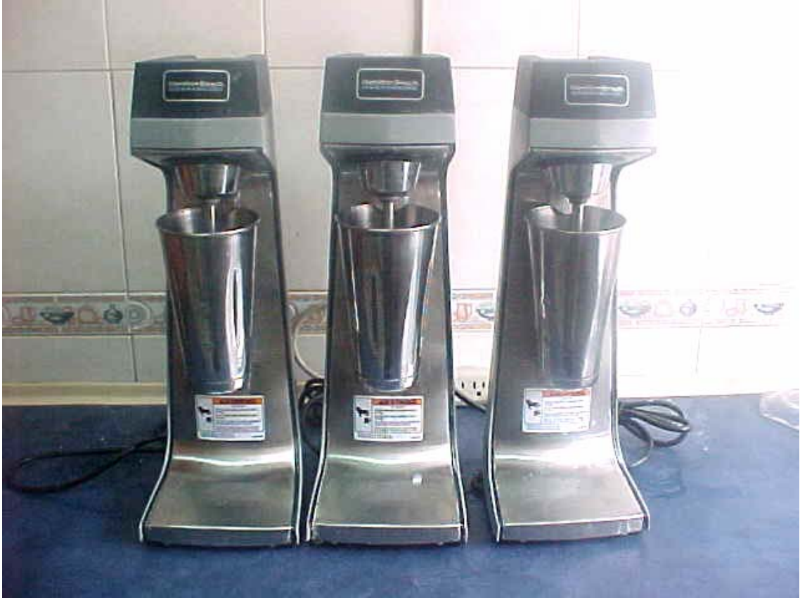
Mezcladores de lodo (mixers)
