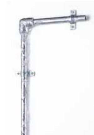
**5.** Los puntos donde la tubería se encuentre empotrada mediante grapas metálicas, deberán llevar dos vueltas adicionales de cinta aislante para brindarle al recubrimiento una mayor resistencia mecánica. Estas vueltas adicionales se instalarán en forma perpendicular al eje de la tubería.
