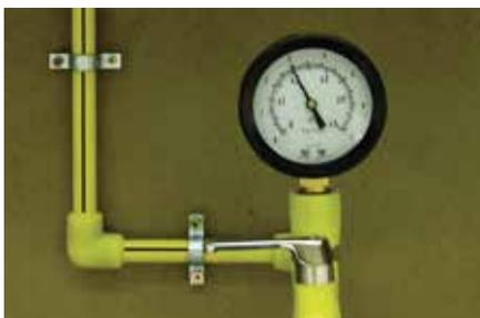
Conforme a lo estipulado en el punto 3.3 de las DISPOSICIONES Y NORMAS MÍNIMAS PARA LA EJECUCIÓN DE INSTALACIONES DOMICILIARIAS DE GAS VIGENTE, la instalación de baja presión soportará, sin pérdidas, una presión neumática manométrica de 0,2 Kg./cm<sup>2</sup> (0,0196 MPa).
