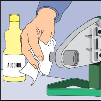
**1.** Limpiar las boquillas del termofusor en caliente con un papel tipo tissue y alcohol común. Y verificar su correcto ajuste a la plancha.
