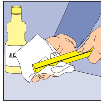
**5.** Se limpia la punta del tubo y el interior del accesorio con un papel tipo tissue humedecido en alcohol común.
