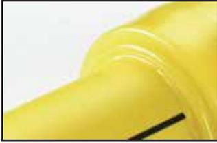
Se trata de fusiones bien ejecutadas, sin defectos observables a simple vista, y que se logran siguiendo las instrucciones de este manual técnico.
