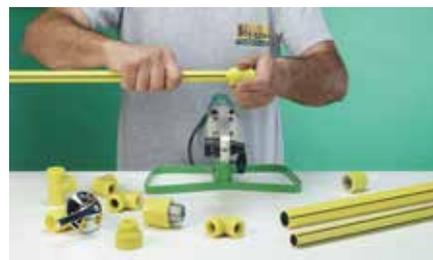
3. Unión por Termofusión
