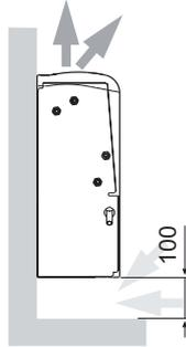
VENTILADOR-CONVECTOR F A SUSPENDIDO EN PARED, ADECUADO PARA INSTALACIÓN EN NICHOS.
