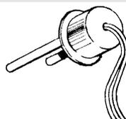
**Termostato de consenso** e rearme automático, interrompe o funcionamento do grupo de ventilação do motor quando a temperatura d'água no interior da bateria de permutação térmica descer para menos do valor previamente fixado (42°C). Serve somente para o funcionamento de aquecimento, há para ser instalado no conjunto com lâminas do permutador de calor.
