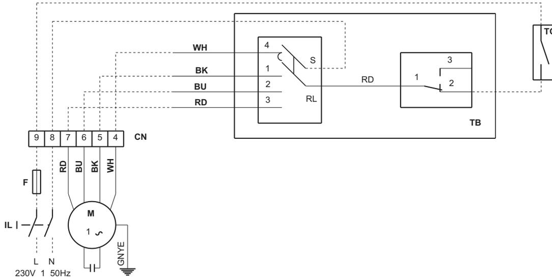
**TB** Painel de comandos com comutador de velocidade e termostato electromecânico para instalação a bordo da máquina
