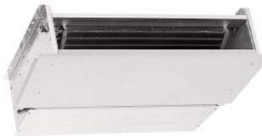
**Batería de intercambio térmico** de gran eficacia, de tubo de cobre y aletas de aluminio ancladas a los tubos mediante expansión mecánica, equipada con colectores de latón y válvulas de desahogo. La batería, generalmente montada con las conexiones en el lado izquierdo, puede ser girada en 180°.
