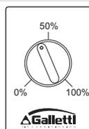
Para instalação a bordo da máquina há, do outro lado, em relação ao painel de comandos do ventilador convector, este comando para abrir e fechar a comporta motorizada SM de maneira proporcional de 0 a 100%.
