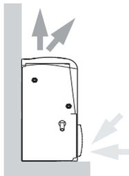
VENTILADOR CONVECTOR FB REBAIXADO DE PAVIMENTO
