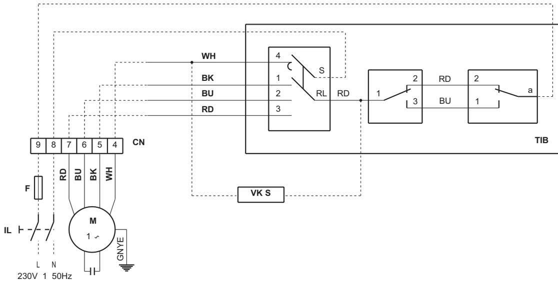
**TIB Painel de comando com comutador de velocidade, termostato e selector aquecimento/refrigeração, para instalação a bordo da máquina**
