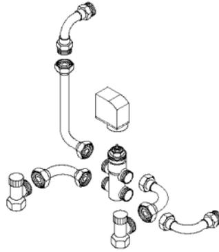
O kit VK válvula de 3 vías / 4 engates motorizada ON/OFF, ligada aos painéis de comando para ventiladores convectores ESTRO, possibilita a regulação da temperatura ambiente ao interromper o fluxo d'água através do permutador de calor. O kit VK está disponível com várias composições para todos os modelos de ventiladores convectores ESTRO, quer para bateria padrão (VK S), quer para bateria adicional de aquecimento DF (VK DF), da maneira indicada na seguinte tabela:
