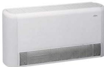
**Móvel de cobertura** constituído por um painel em chapa de aço de grande espessura (10/10 mm.), painéis laterais, grade de vazão (orientáveis 180°) e grades de retomada realizadas em ABS. As portinhas laterais possibilitam acesso aos vãos técnicos e ao painel de comando (acessório).
