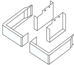
Os rodapés de cobertura ZA, que servem para a montagem na série ESTRO FA, são fornecidos em pares e são constituídos por suportes para prender o aparelho básico e por coberturas exteriores para prender no móvel. São utilizados para esconder os tubos hidráulicos (provenientes do pavimento) e quando não for possível prender o ventilador convector na parede. A altura dos rodapés de cobertura é de 100 mm.
