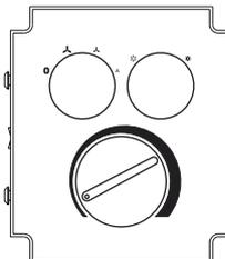
Para instalação a bordo da máquina há, do outro lado, em relação ao painel de comandos do ventilador convector, este comando para abrir e fechar a comporta motorizada SM de maneira proporcional de 0 a 100%. Não é possível utilizar o painel de comandos CSB se o ventilador convector for equipado com uma bateria adicional DF (acessório, sistemas de 4 tubos); neste caso a abertura da comporta motorizada SM deve ser comanda pelo painel de comandos de parede CSD.
