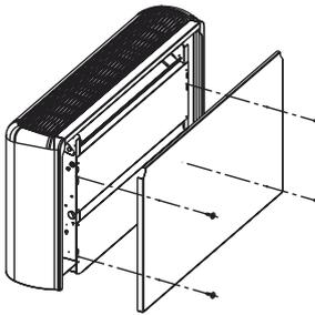
Este acessório é fornecido para instalação de ventiladores convectores FB com a parte traseira à vista. Por exemplo: instalação encostado em paredes em vidro. Os ventiladores convectores que utilizam o fecho traseiro PVB não podem ser presos na parede.
