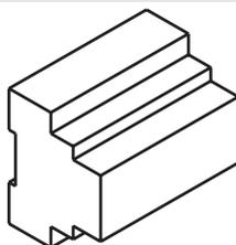
A interface de potência KP é utilizada para comandar com um único painel de comandos até 4 ventiladores convectoros (ligados em paralelo). Pode ser montada na guia Din, que normalmente encontra-se nos quadros eléctricos, é pode ser combinada com todas as versões da série ESTRO.
