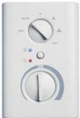
Painel de comando com microprocessador para instalação a bordo da máquina (MICROPRO) ou de parede (MICROPRO-D) equipado com comutador de velocidade, termostato electrónico e selector das estações do ano; realiza a gestão automática da ventoinha ao agir nas válvulas e resistência eléctrica que houver. Comando das velocidades da ventoinha, regulação da temperatura ambiente e comutação da modalidade de funcionamento (verão/inverno).
