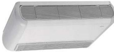
**Unidad base** en chapa de acero galvanizado de gran espesor (hasta de 15/10 mm), aislado mediante paneles termoaislantes autoextinguibles de Clase 1 y provista de un kit de instalación (tornillos de pared). La máquina está equipada con un doble sistema de recepción y descarga de condensación. La recepción de la condensación, en caso de instalación horizontal, se efectúa mediante una amplia cubeta.
