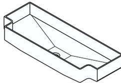
Este acessório utiliza-se para a colecta da condensação que vier a formar-se na válvula e no detenedor. Pode ser utilizado para os ventiladores convectores de instalação vertical FL, FA, FU, FC, FB.
