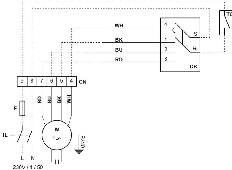
**CB** Painel de comando com comutador de velocidade para instalação a bordo da máquina
