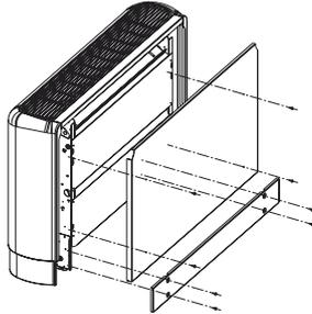
Este acessório é fornecido para instalação de ventiladores convectores FL e FU com a parte traseira à vista. Por exemplo: instalação encostado em paredes em vidro. O kit é constituído por um fecho traseiro superior e por um fecho traseiro inferior. Os ventiladores convectores que utilizam o fecho traseiro PVL não podem ser presos na parede.
