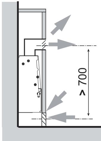
VENTILADOR CONVECTOR DE ENCAIXAR FC INSTALADO VERTICALMENTE (DE PAREDE)
