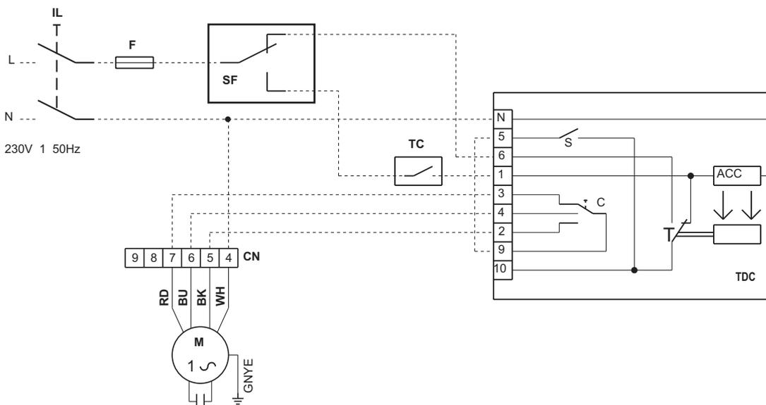
**TDC Painel de comandos de parede com comutador de velocidade e termostato**
