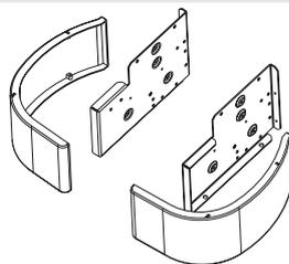
Os rodapés de cobertura ZL, servem para a montagem na série ESTRO FL, são fornecidos em pares e são constituídos por suportes para prender o aparelho básico e por coberturas exteriores para prender no móvel. São utilizados para esconder os tubos hidráulicos (provenientes do pavimento) e quando não for possível prender o ventilador convector na parede. A altura dos rodapés de cobertura é de 100 mm.
