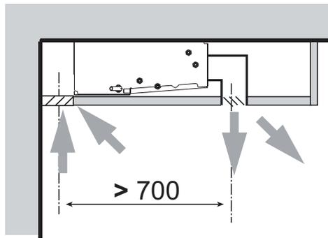
VENTILADOR CONVECTOR DE ENCAIXAR FC INSTALADO HORIZONTALMENTE (EM TECTO FALSO)
