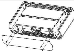
O painel traseira pintado PH é fornecido exclusivamente para os ventiladores convectores da série ESTRO FU instalados no tecto, com a parte traseira à vista com a finalidade de esconder os vãos técnicos (hidráulico e eléctrico). Utiliza-se para esconder os vãos técnicos. Os ventiladores convectores que utilizam painel traseiro podem funcionar exclusivamente em fase de aquecimento
