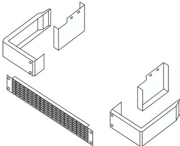
Os rodapés de cobertura ZAG, servem para a montagem na série ESTRO FA, são fornecidos em pares e são constituídos por suportes para prender o aparelho básico, por coberturas exteriores para prender no móvel e por grade para esconder a frente. São utilizados para esconder os tubos hidráulicos (provenientes do pavimento) e quando não for possível prender o ventilador convector na parede. A altura dos rodapés de cobertura é de 100 mm.
