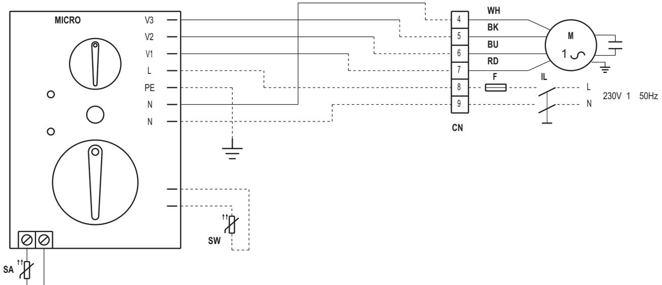
8 ESQUEMAS DE CONEXIÓN ELÉCTRICA
