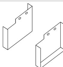
Os estribos de suporte D, são fornecidos em pares e correspondem a ventiladores conectores de encaixar na parede da série ESTRO F C quando não for possível prendê-los na parede. A altura das estribos de suporte é de 100 mm.
