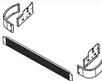
Os rodapés de cobertura ZLG, servem para a montagem na série ESTRO FL, são fornecidos em pares e são constituídos por suportes para prender o aparelho básico e por coberturas exteriores para prender no móvel e grade para esconder a frente. São utilizados para esconder os tubos hidráulicos (provenientes do pavimento) e quando não for possível prender o ventilador convector na parede. A altura dos rodapés de cobertura é de 100 mm.
