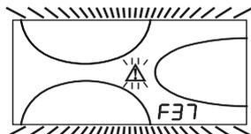
fig. 15 - Anomalía presión insuficiente en la instalación
