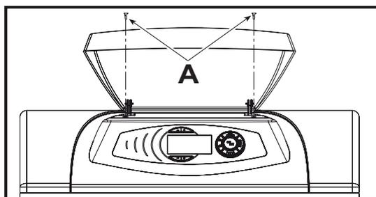
fig. 16 - Acceso a la regleta de conexiones
