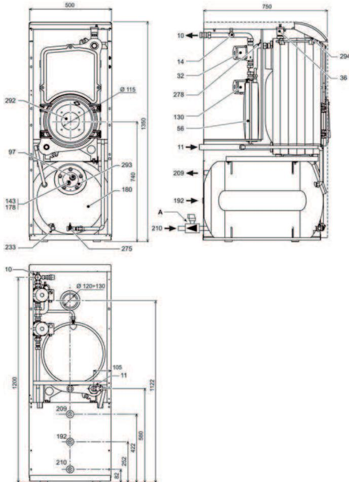
fig. 18 - Dimensiones, conexiones y componentes principales
