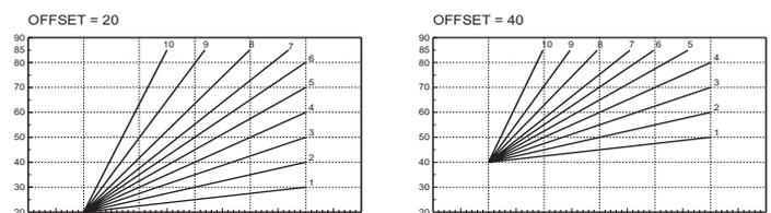
fig. 14 - Ejemplo de desplazamiento paralelo de las curvas de compensación
