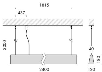
**barra d'oro fissa** 240V 50-60Hz **A ECG** **IP20** **F** **CE** **i**
