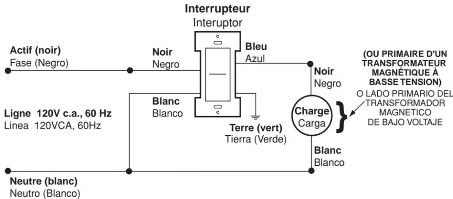
**Schéma de câblage 2 – Commande depuis plusieurs emplacement charges à incandescence / fluorescentes / magnétiques à basse tension**
