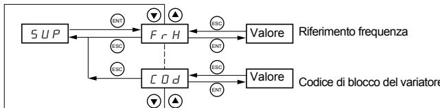
Quando il variatore è in funzione il valore visualizzato corrisponde al valore di uno dei parametri di visualizzazione. Di default il valore visualizzato è il riferimento del motore (parametro FrH).
