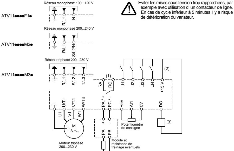
**Nota :** Equiper d'antiparasites tous les circuits selfiques proches du variateur ou couplés sur le même circuit (relais, contacteurs, électrovannes,...)
