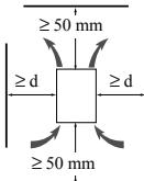
Installare il variatore in posizione verticale a  $\pm 10^\circ$ .
