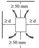
Installer l'appareil verticalement, à  $\pm 10^\circ$ .
