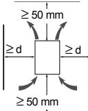
Die Installation des Gerätes erfolgt vertikal, bis  $\pm 10^\circ$ .
