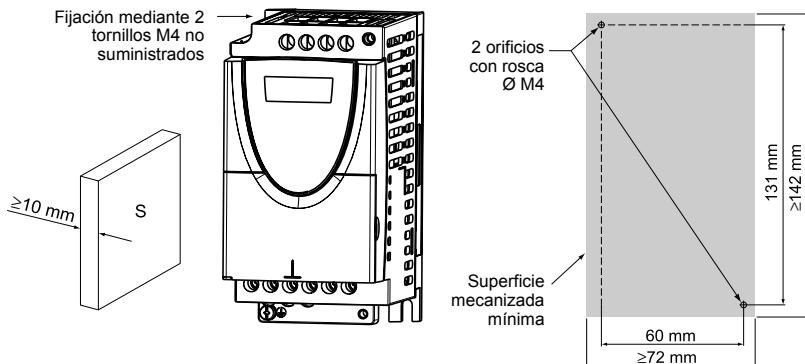
Compruebe el estado térmico del variador con el parámetro tHd (menú SUP) para validar la correcta eficacia del montaje.
