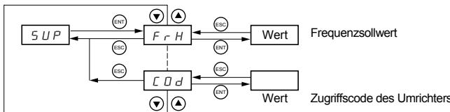
Wenn der Umrichter in Betrieb ist, entspricht der angezeigte Wert dem Wert eines der Überwachungsparameter. Standardmäßig ist der angezeigte Wert der Frequenzsollwert des Motors (Parameter FrH).
