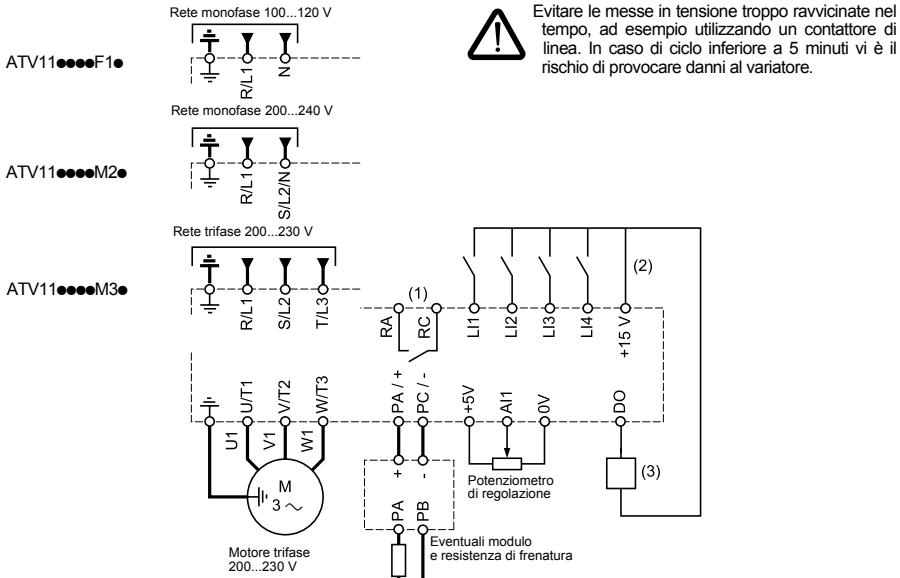
**Nota:** Dotare di moduli antidisurbo tutti i circuiti induttivi vicini al variatore o collegati sullo stesso circuito (relé, contattori, elettronvalvole, ecc...)
