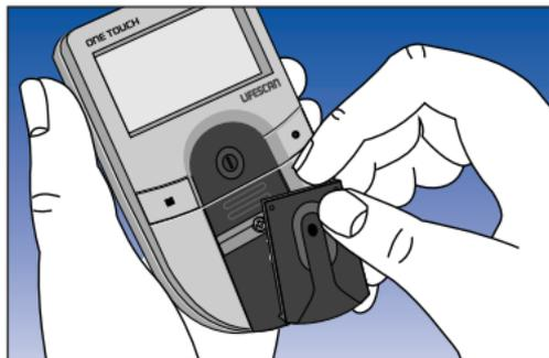
Enganche la parte inferior del sujetador de la tira de prueba sobre la muesca cuadrada del medidor.
