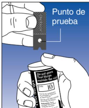
primero deslice el extremo ranurado de la tira de prueba en el sujetador de la tira de prueba, con el punto de prueba hacia arriba. Asegúrese de empujar la tira de prueba completamente hasta que llegue a un tope.
