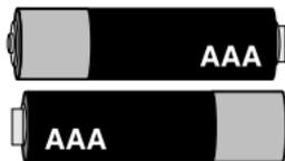
El medidor OneTouch® Basic® incluye las baterías ya instaladas. Cuando sea necesario cambiarlas, utilice dos baterías alcalinas AAA, de 1.5 voltios.
