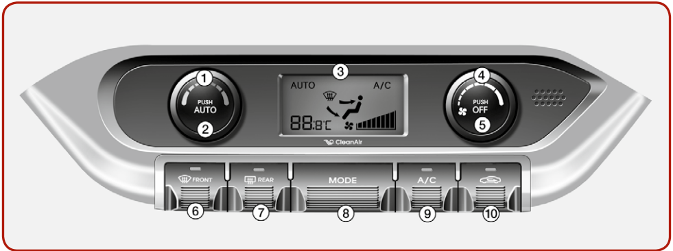
Sistema automático de control de clima* [4]
