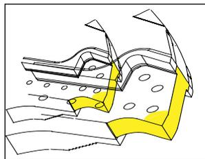
Área **amarilla** - cuando sea necesario, refuerce el borde delantero inferior de la lengüeta y la superficie vertical delantera de la mordaza superior. Después de soldar, las superficie deberán cuadrarse con un afilador y terminarse con una lima y la regla de taller. Es primordial que la base de la cuchilla de perforación y las superficies de la espiga estén derechas y sean reales, sin abolladuras, deformaciones, puntos bajos o depresiones, o áreas desgastadas.
