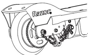
**1** Retire la rueda y coloque la rueda de reemplazo.
