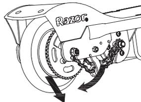
**3** Para aflojar la cadena, empuje el traccionador hacia abajo para crear cierta holgura en la cadena.
