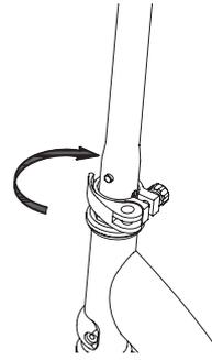
3 Ajustar la tensión del cierre rápido, hasta poder cerrar la palanca completamente, para asegurar la tija.
