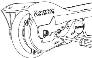
**1** Afloje los tornillos y retire el cubrecadena.
