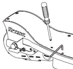
2 Desenroscar los cuatro tornillos en el medio de la plataforma.
