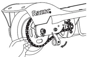
**5** Empuje el traccionador de la cadena hacia abajo para instalar la cadena en las dos ruedas dentadas.
