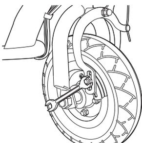
**1** Aflojar el perno del cable de freno.
