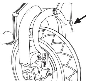
**2** Si está demasiado tenso u holgado, aflojar el cable de freno y ajustarlo adecuadamente.
