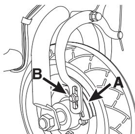
**3** Comprobar que las pastillas de freno (A) estén bien alineadas con la rueda y no presenten desgaste excesivo. Para realinear las pastillas de freno, aflojar la tuerca de fijación (B) y ajustar la pastilla, para que tome contacto con la llanta. Reapretar y controlar. Volver a ajustar, si fuera necesario.
