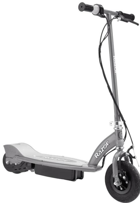
**⚠ NOTA:** Los modelos E100 deben alcanzar los 5 km/h, antes de que se ponga en marcha el motor. Se impulsan con el pie, hasta alcanzar los 5 km/h, mientras se acelera, para poner en marcha el motor.
