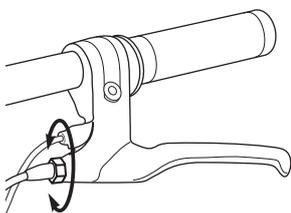
**1** Girar el tensor de la maneta de freno de 1/4 a 1/2 giro, hasta obtener el ajuste de freno deseado. Si aún fuera necesario ajustarlo, seguir con el paso 2.
