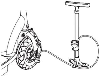
1 Inflar el neumático delantero hasta la presión en PSI, indicada en la banda lateral del neumático.
