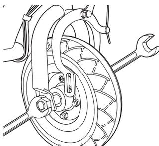
**2** Aflojar los pernos de eje delantero. Retirar la rueda y colocar la rueda de recambio.
