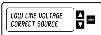
**BAJO VOLTAJE DE LINEA. CORRIJA LA FUENTE DE PODER (LOW LINE VOLTAGE. CORRECT SOURCE)** Chequee el voltaje en su origen. El poder de la electricidad puede disminuir si:
