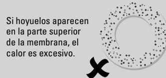
Si hoyuelos aparecen en la parte superior de la membrana, el calor es excesivo.
