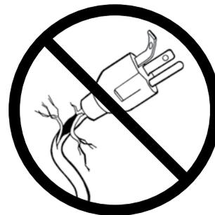
**SI EL CORDON ELECTRICO ESTA DAÑADO,** pare de usar el aparato y contacte a su Técnico de Servicio autorizado del Sistema RhinoBond para que repare su sistema.
