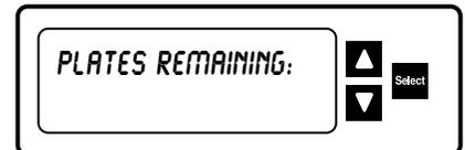
**PLACAS FALTANTES (PLATES REMAINING)** le permite ver el número de placas que aun faltan por soldar en un trabajo determinado.
