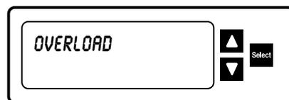
**SOBRECARGA (OVERLOAD)** RhinoBond sentidos de metal excesivo. La herramienta se puede estar demasiado cerca de la estructura metálica. Trate de activar la herramienta cuando se está apuntando hacia el cielo.
