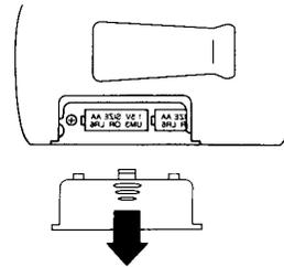
2. Instale 2 baterías AA conforme a los símbolos de polaridad (+y-) marcados dentro del compartimiento de baterías.
