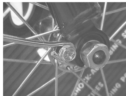
Lower Mounting Screw Vis de montage inférieur Tornillo de montaje inferior
