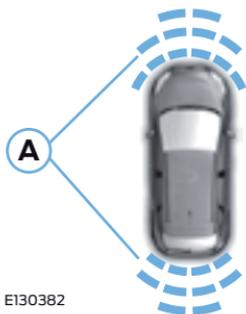
**A** Zona de cobertura de hasta 80 cm desde la parte delantera del vehículo; hasta 183 cm desde el paragolpes trasero y entre 15 y 35 cm hasta el lateral del extremo delantero del vehículo.
