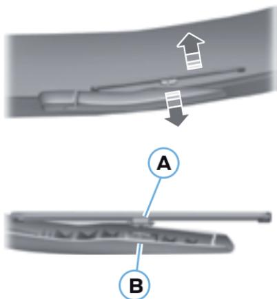
3. Para montar nuevamente la escobilla, alinee la ranura **A** de la escobilla con el perno **B** del brazo y presione firmemente hasta oír clic.
