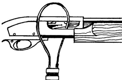
Con el cerrojo fijado en la posición abierta, insertar el cable a través de la boca de expulsión y sacarlo por la boca de carga. **Para cerrar el candado:** Deslizar el extremo suelto del cable dentro del candado hasta que haga clic y quede así en posición trabada. Quitar la llave. Verificar que el cable esté firme.
