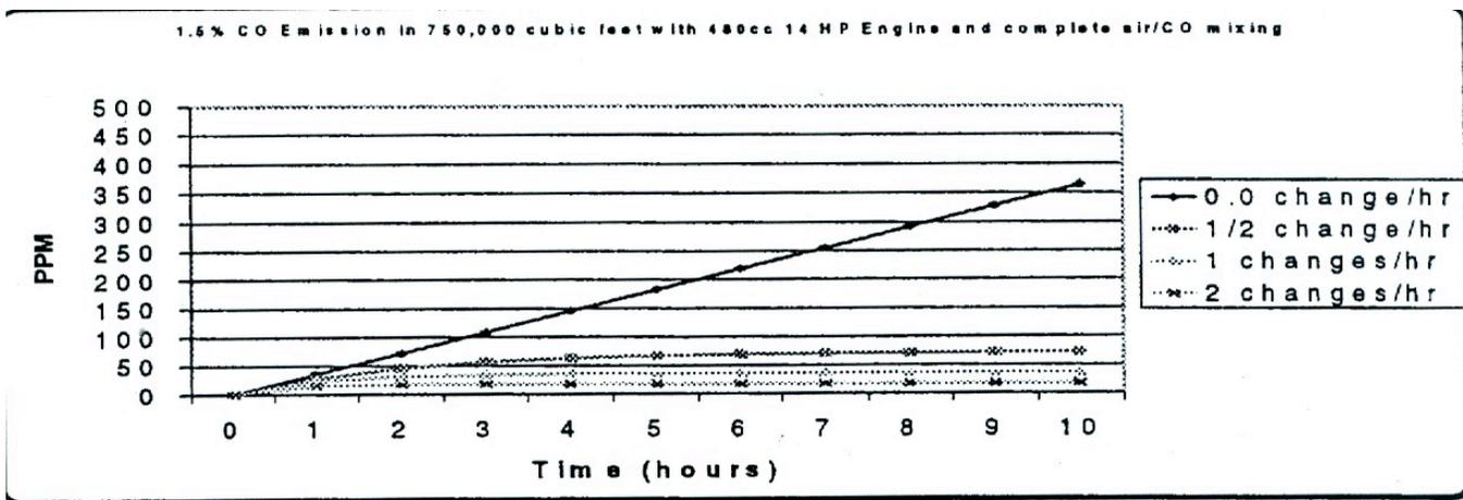
Basados en los rangos de producción mostrados arriba, el TWA estaría excedido en una habitación vacío de 100X500X10 pies después de 6 horas y dos intercambios de aire por hora (se asume que no hay exposición adicional al CO durante un periodo de 8 horas).
