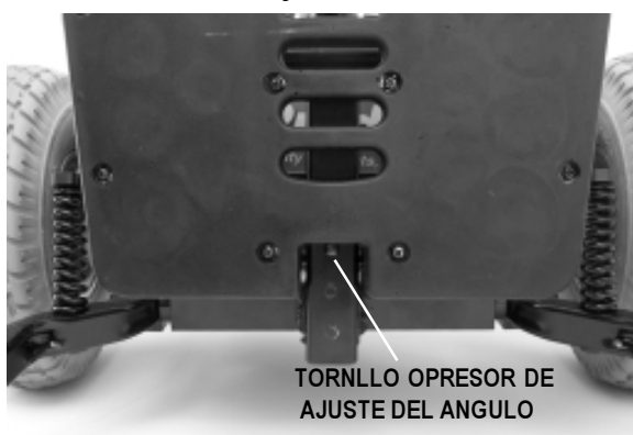
Figura 13. Ajuste del Angulo del Apoyapie
