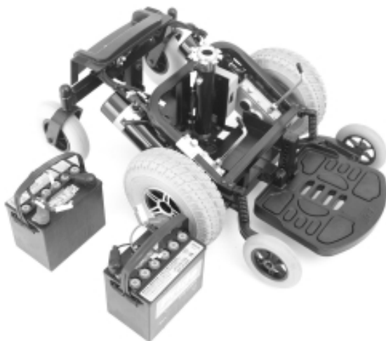
Figura 22. Baterías Removidas de Jet 3
