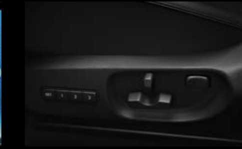
Asiento eléctrico del conductor con ajuste de 8 posiciones, soporte lumbar y memoria para 3 posiciones*.
