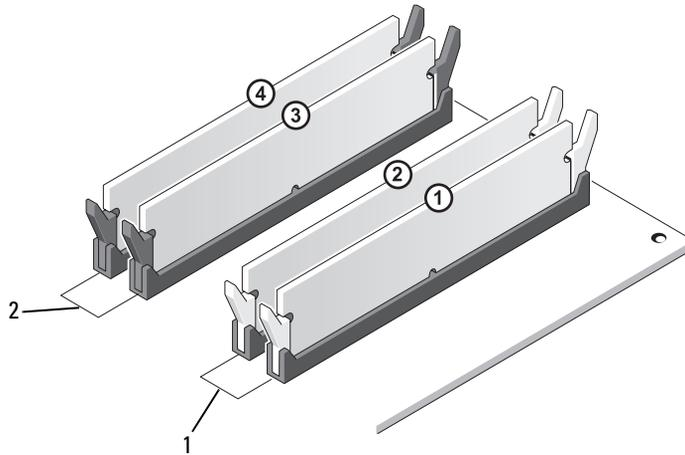
1 Canal A: Par de módulos de memoria coincidentes en los conectores DIMM\_1 y DIMM\_2 (ganchos de fijación blancos)
