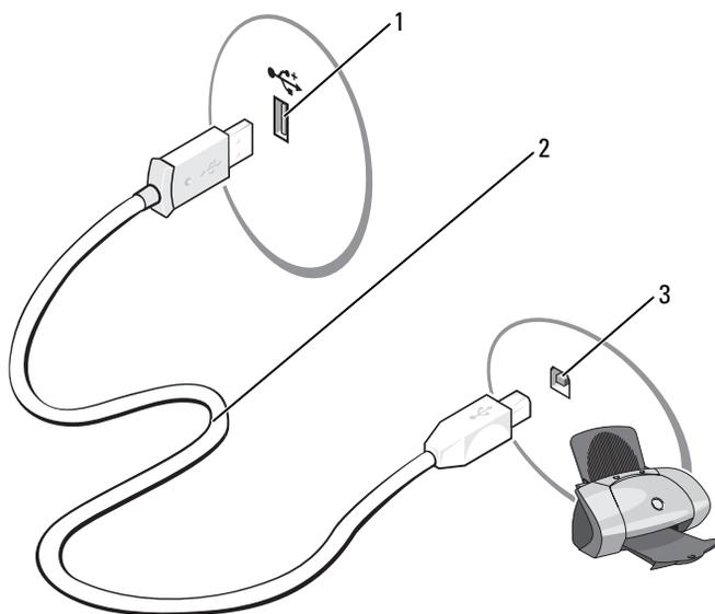
1 Conector USB del ordenador    2 Cable de impresora USB    3 Conector USB de la impresora
