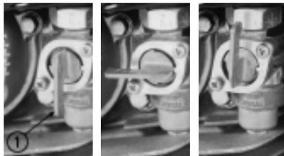
(1) Válvula del tanque de combustible
