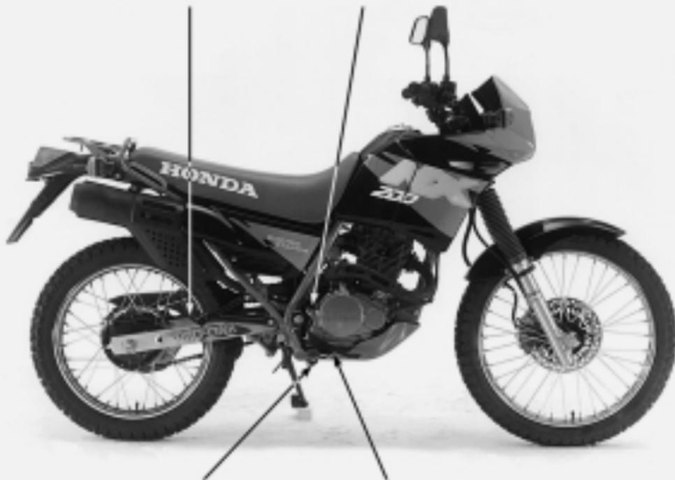
Descansapie del piloto Pedal del freno trasero
