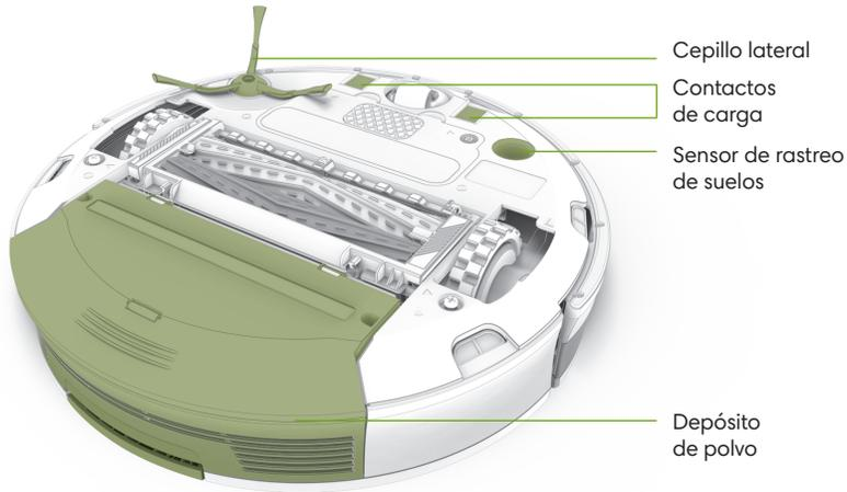
**Componentes y cabezal de limpieza**
