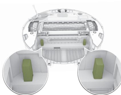
**3** Limpie los puertos de los sensores interiores y exteriores del depósito con un paño seco y limpio.
