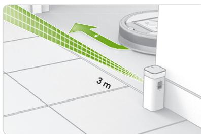
**Modo Virtual Wall:** cuando el interruptor se encuentra en la posición "superior" (☺), el dispositivo funciona como Virtual Wall. Esto significa que puede configurarlo para bloquear aberturas de hasta 3 metros. Crea una barrera invisible en forma de cono que solamente Roomba puede ver.
