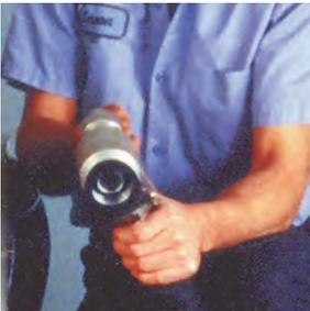
Un cepillo flexible ubicado en el cabezal de chorreado contiene el polvo y el abrasivo.
