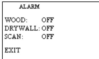
3. En cuanto se encienda la alarma, use la tecla  $\Rightarrow$  para aumentar el valor de la alarma y la tecla  $\Leftarrow$  para disminuir el valor de la alarma.
