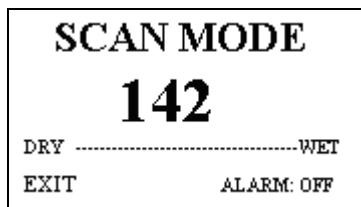
3. Puede empezar a tomar lecturas presionando firmemente la parte posterior del medidor de humedad contra el material a medir. Esto visualizará una lectura relativa en un rango entre 0 y 300.
