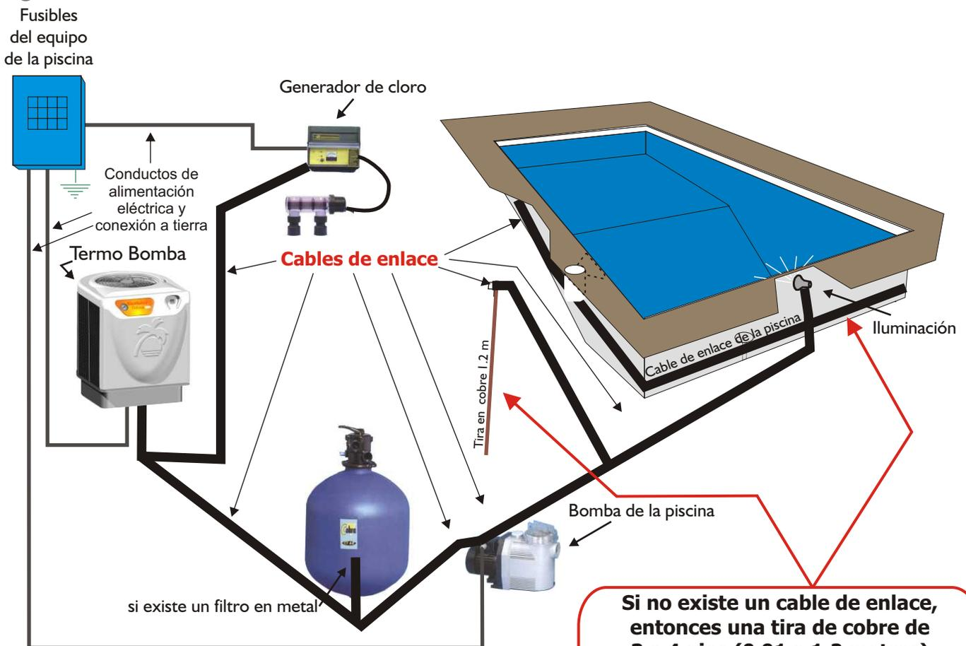
**Si no existe un cable de enlace, entonces una tira de cobre de 3 a 4 pies (0.91 a 1.2 metros) debe ser incrustada en el suelo cerca del equipo de la piscina con el fin de enlazar todo el mecanismo.**
