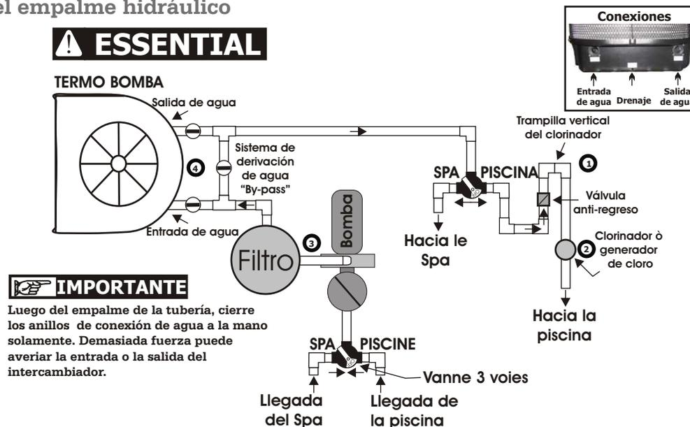
1. Una compuerta anti-regreso de 1/3 de libra o una trampa debe ser instalada entre la termo bomba y todo tipo de distribuidor de cloro automático, a fin de prevenir todo retorno posible al aparato de agua altamente concentrada en cloro, una vez que la bomba de la piscina se apaga.
