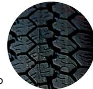
Los indicadores de desgaste de banda incorporados, o "barras de desgaste", que parecen franjas angostas de caucho liso sobre la banda, se harán visibles en la llanta cuando la banda se haya gastado a 2/32 de una pulgada. Cuando vea estas "barras de desgaste", sabrá que su llanta se ha gastado y debe reemplazarla.
