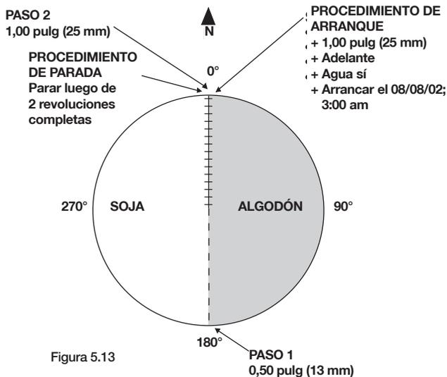
Se escribirán dos programas para este ejemplo. El primer programa arranca el equipo a las 3:00 am del 08/08/02, cambia la profundidad de aplicación del agua a 0,50 pulg (13 mm) a 180 grados, cambia la profundidad de aplicación a 1,00 pulg (25 mm) a 0 grados y carga el segundo programa. El segundo programa entonces cambia la profundidad de aplicación del agua a 0,50 pulg (13 mm) a 180 grados y para el equipo a 0 grados, lo cual completa el segundo ciclo.
