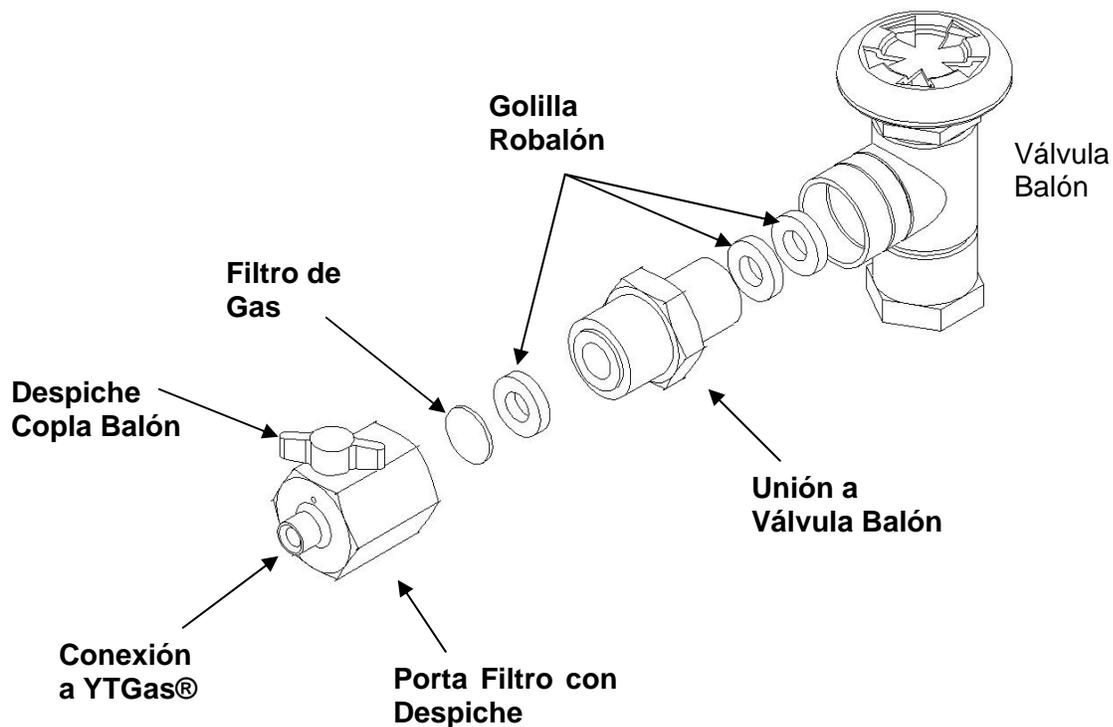
Para desmontar el filtro de gas, debe primero apagar el equipo y cerrar la válvula de gas del balón. En un lugar ventilado, abra el **despiche copla balón**, para liberar cualquier resto de gas del circuito. Hecho esto, suelte la manguera que va hacia el equipo.
