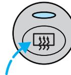
**!** Para efectuar la limpieza interna de la luneta trasera nunca use solventes o productos abrasivos. Evite colocar objetos puntiagudos en el portaequipajes o colocar adhesivos en la luneta trasera pues podría dañar los elementos cerámicos de calefacción.
