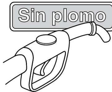
En los vehículos con motores a nafta el tubo del depósito de combustible tiene un diámetro estrecho que sólo admite la boquilla de la pistola de los surtidores de nafta sin plomo.
