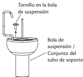
Figura 13 - Forma de retirar el tornillo de la bola de suspensión
