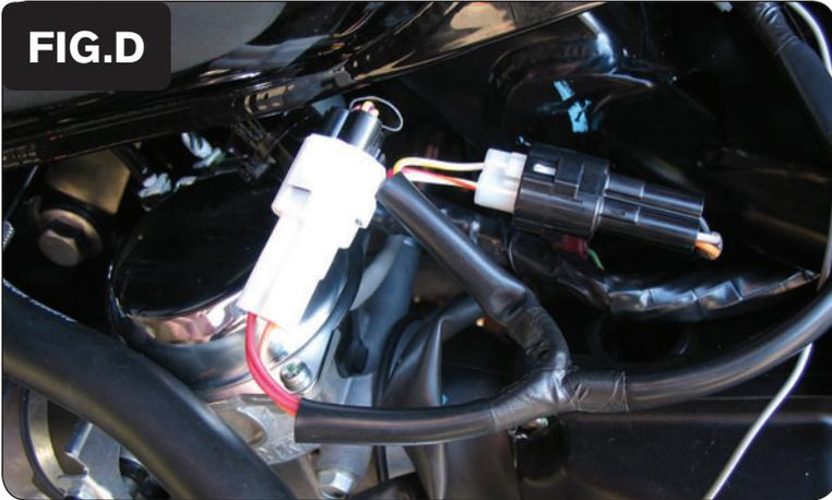
8. Conectar el mazo de cables del PCV en línea con los conectores de serie (Fig. D).
