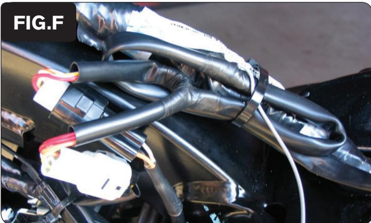
11. Sujetar el mazo de cables del PCV al mazo de cables principal con la banda de sujeción que se suministra (Fig. F).
