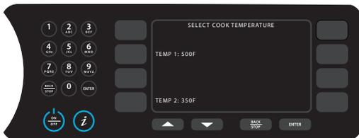
Figura 6: Seleccione la temperatura de cocción
