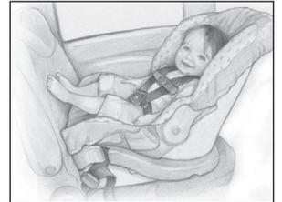
Figura 1: Asiento de seguridad para el automóvil solamente orientado hacia atrás.
