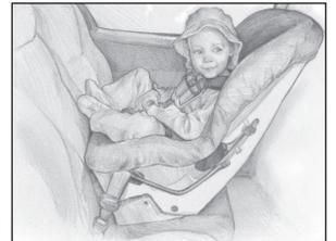
Figura 2: Asiento de seguridad para el automóvil convertible utilizado hacia atrás.
