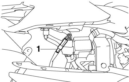
1. Acoplador del cable de la luz de intermitencia
