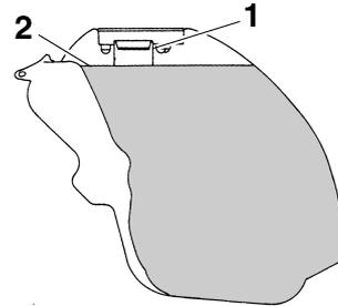
1. Tubo de llenado del depósito de gasolina
