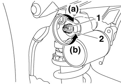
1. Perno de ajuste del hidráulico de compresión (para una amortiguación rápida en compresión)
