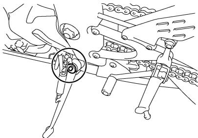
Antes de cada utilización debe comprobar el funcionamiento del caballete lateral y engrasar el pivote y las superficies de contacto metal-metal si es necesario.
