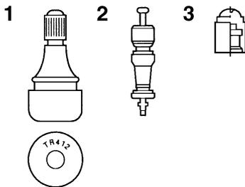
1. Válvula de aire del neumático
