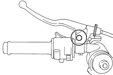
Cada vez que conduzca, debe antes verificar el funcionamiento de las manetas de freno y embrague y engrasar los pivotes de las manetas si es necesario.
