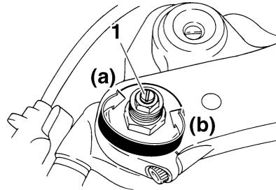
1. Tornillo de ajuste del hidráulico de extensión
