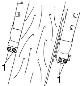
1. Remache de plástico desmontable del eje de la rueda delantera
