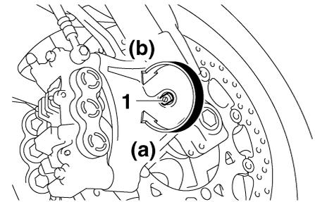
1. Tornillo de ajuste del hidráulico de compresión
