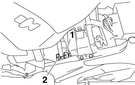
1. Fusible del sistema de inyección de gasolina
