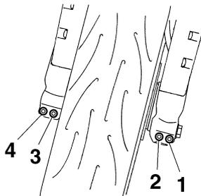
1. Remache de plástico desmontable del eje de la rueda delantera A
