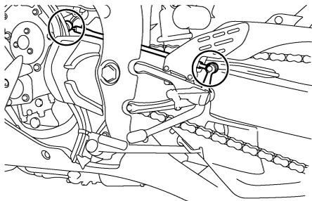
Antes de cada utilización debe comprobar el funcionamiento del pedal de cambio y engrasar los pivotes de la varilla del mismo según sea necesario.
