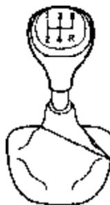
Aplicar el freno de estacionamiento y colocar la marcha atrás o la 1ª velocidad.
