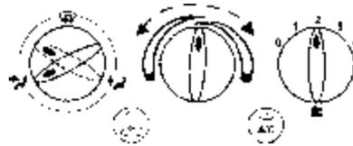
**Nota:** si la perilla de regulación del ventilador estuviera en la posición "0", el ventilador estará desconectado.
