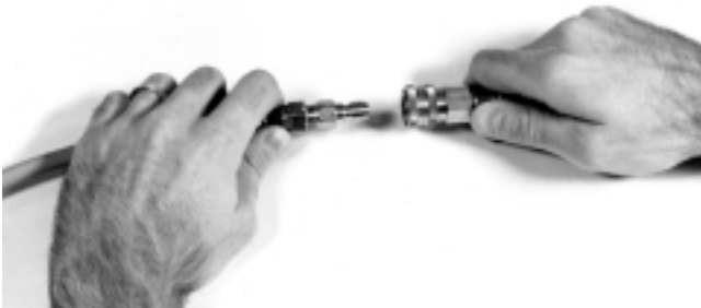
Figura 2 – Conexión de la manguera de la limpiadora a chorro
