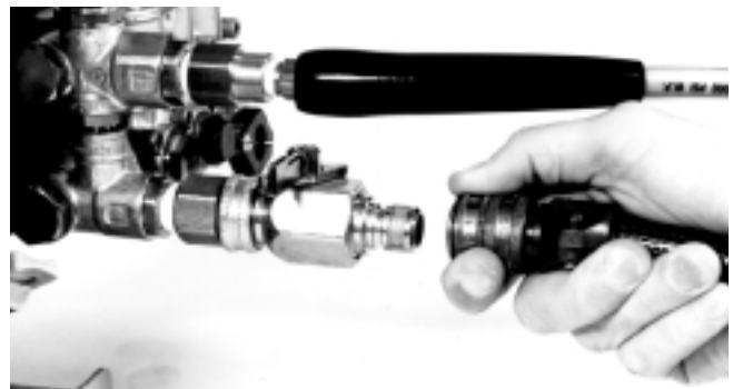
Figure 1 – Raccordez l'arrivée d'eau au dégorgeoir. Fermez le robinet d'arrivée (montré en position fermée).
