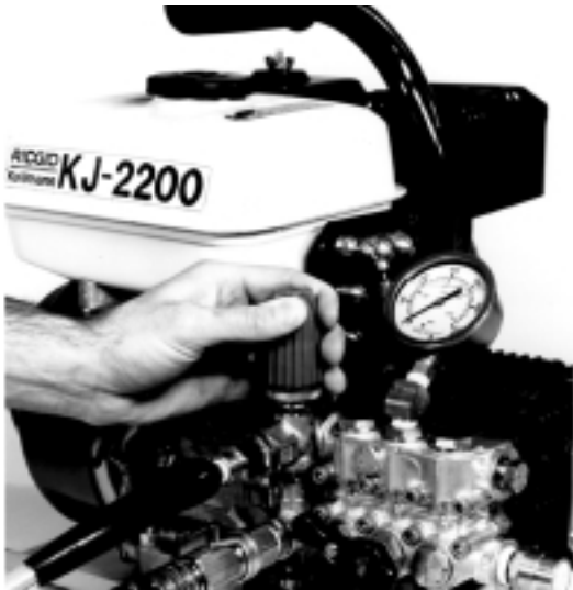
Figura 4 – Regulación de la válvula de descarga
