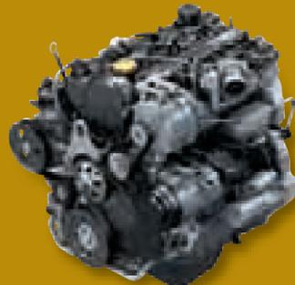
El motor 2.8 CRD (Common-Rail Diesel) de cuatro cilindros con doble árbol de levas en cabeza (DOHC) y 16 válvulas ofrece 177 CV y un par máximo de 410 Nm entre 2.000 y 2.600 rpm\*.
