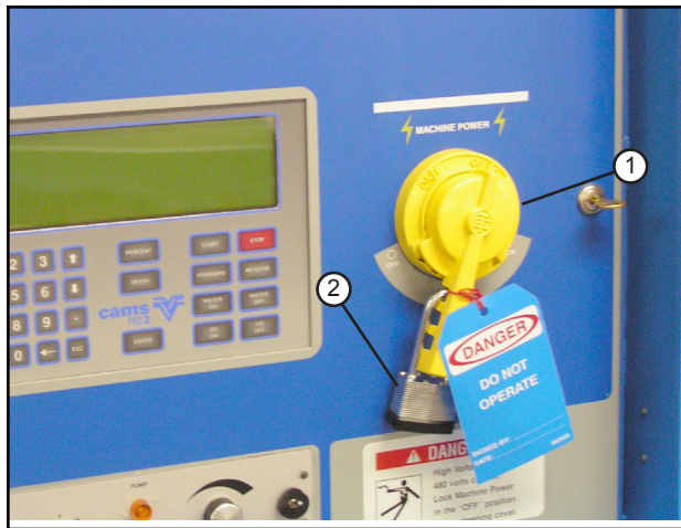
Figura 13-1 1. Interruptor principal de alimentación 2. Bloqueo
