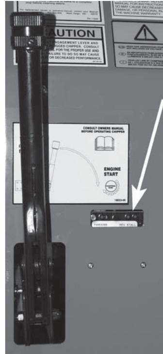
La chipeadora está equipada con un controlador de alimentación preprogramado ubicado junto a la manija del embrague. El controlador supervisa las revoluciones por minuto del rotor de la chipeadora, controla el rodillo de alimentación y provee alertas de mantenimiento de rutina.
