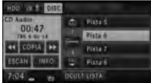
Cambie entre los menús de medio y radio pulsando la tecla fija RADIO/MEDIA. Los diferentes modos de medio pueden seleccionarse mediante las pestañas en la pantalla de la radio.
